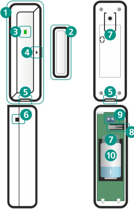
1. Основной элемент (магнитоуправляемый)
