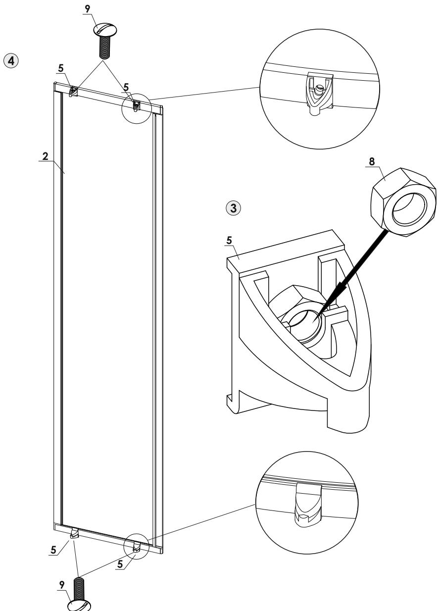
4. Заправьте дверцы в направляющие каркаса, одновременно заводя верхнюю и нижнюю петли в зацепление с направляющей (рис. 5).
