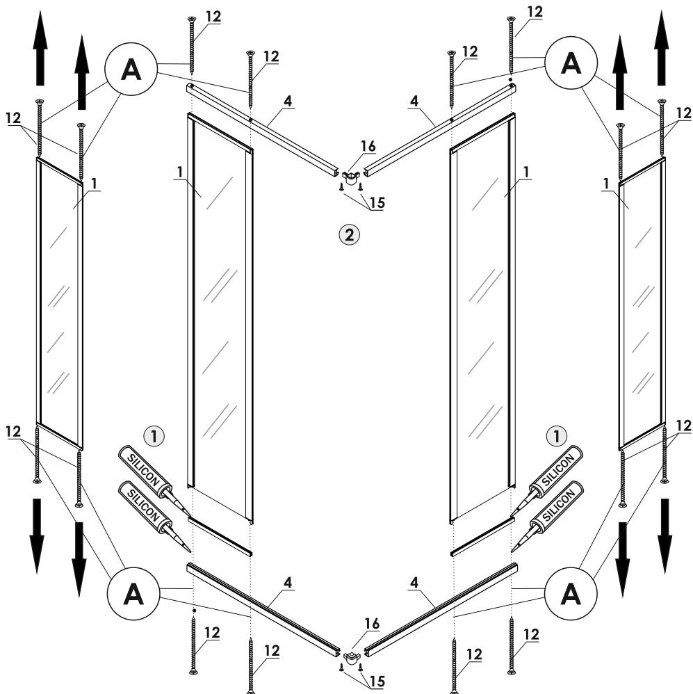
2. Закрепите направляющие дверей к панелям выкрученными на предыдущем шаге шурупами.
