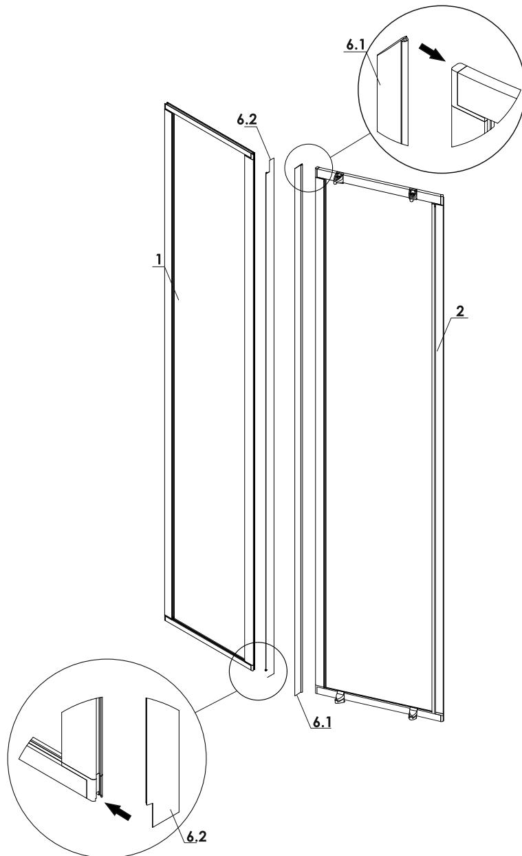
6. Оденьте установочный профиль на изделие (рис.8). Поставьте душевое заграждение по месту установки, нанесите разметку в местах крепления к стенам. Используйте строительный уровень.
