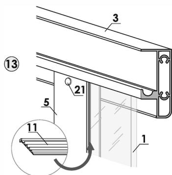
14. В пазы стоечных профилей установите водоотводной уплотнитель крылом внутрь (рис.14).
