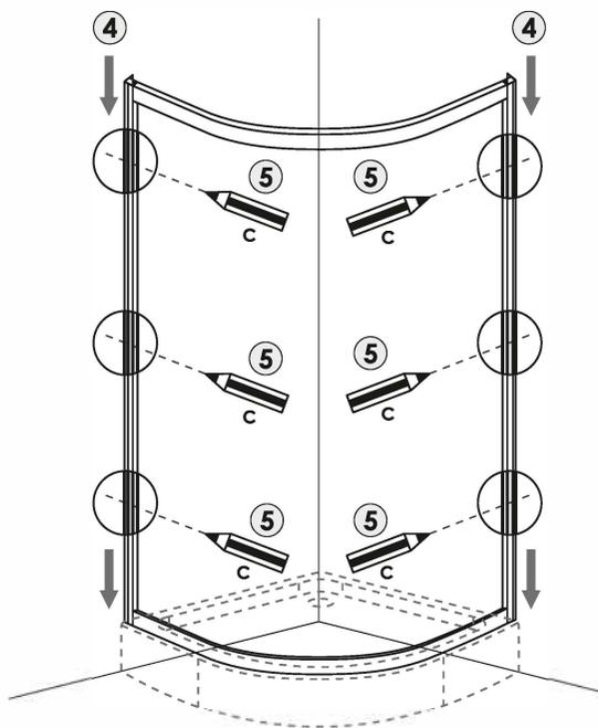
6. Просверлите стены и установочный профиль (рис.6).
