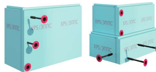
Торцевой стык плит теплоизоляции
