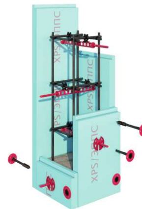
Устройство колонны / свайного фундамента
