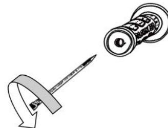
инструментом для нанесения разметочных рисок (рис. 1). Она изготавливается из круглой инструментальной стали. Рабочий конец твердосплавного карандаша закаливают до твердости 55–58 HRC и остро затачивают.
