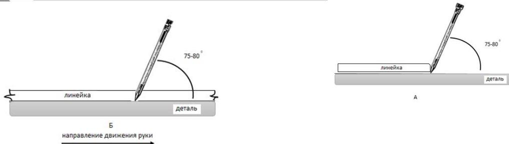
Прямые линии наносят чертилкой, которая должна быть наклонена в сторону от линейки. Углы наклона должны соответствовать указанным на рисунке и не изменяться в процессе нанесения рисок, иначе риски будут не параллельными линейке.
