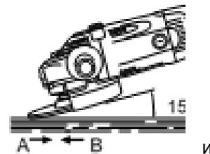
рукоятку. Включите инструмент и поднесите круг или диск к обрабатываемой детали.
